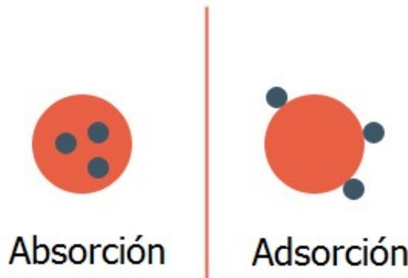
Figura 1.2: Diferencia entre absorción y adsorción.
